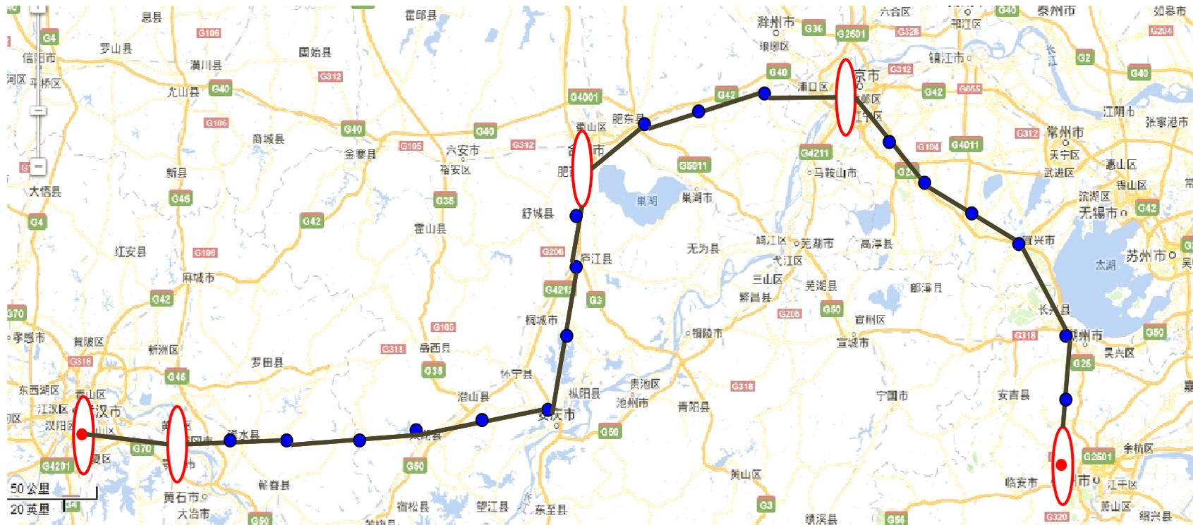
中国电信100G试验网杭州~福州段，涉及湖北、安徽、江苏、浙江四个省份，全程1280公里，包含武汉、杭州2个OTM站，合肥、南京、黄冈3个ROADM站，光放大站18个。系统总计共22个跨段，比中国电信集团测试最长系统配置还多2个跨段，体现中兴通讯100G解决方案的超强传输能力。
