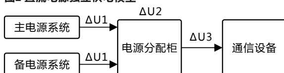
图2 直流电源独立供电模型
